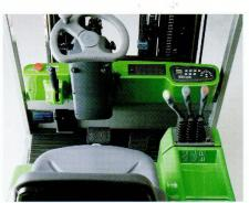
Facilmente accessibile, dotato di una comoda pedaliera di tipo automobilistico e di comandi facilmente raggiungibili, il posto guida ergonomico è concepito in funzione del massimo comfort dell'operatore.
