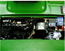
I controllo elettronico, collocato nel vano posteriore, consente la programmazione dei diversi parametri operativi, in funzione delle prestazioni richieste dalla specifica applicazione.
