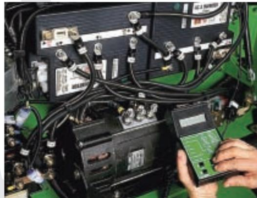
Il controllo elettronico, collocato nel vano posteriore protetto, consente la programmazione dei diversi parametri in funzione delle prestazioni desiderate. La diagnostica è agevolata dal facile accesso al comando.
